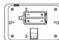
**Upozorenje:** Baterije treba izvaditi ako se termostat ne bi koristio dulje vrijeme (dulje od 15 dana). Inače će se pojavitvi neispravnost rada termostata za koju se ne priznaje jamstveno pravo.
