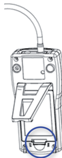
Slika 2 Otvaranje poklopca pretinca za baterije
